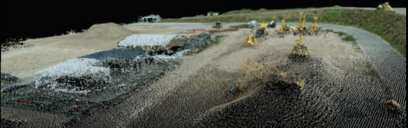
Die von der Edge Box auf Basis der photogrammetrisch ausgewerteten Bilddaten errechnete Punktwolke des Komatsu-Areals
