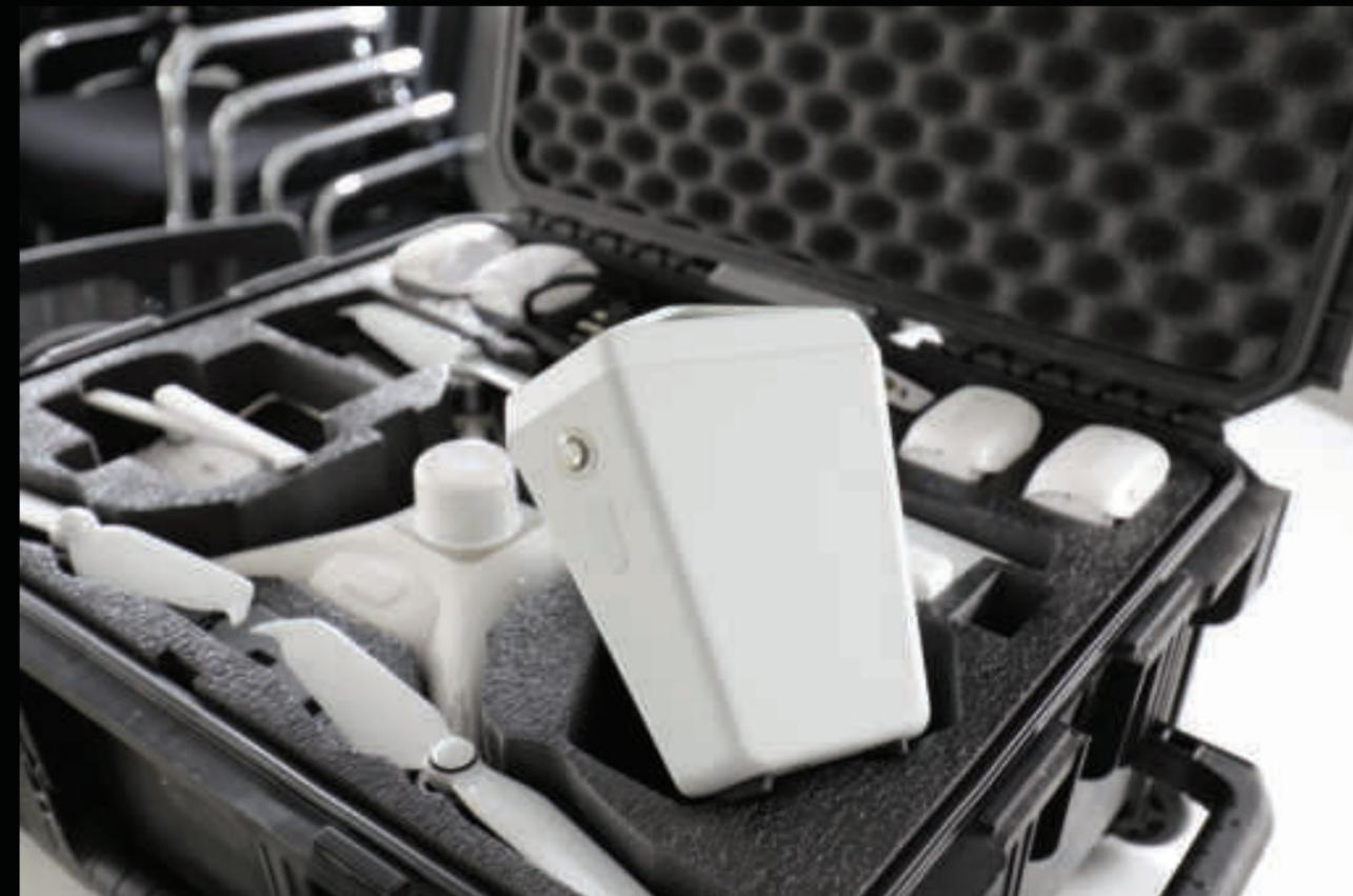
Die DJI-RTK-Drohne, die zugehörige Fernsteuerung, die Edge Box und zahlreiche Akkus sind in einem Koffer untergebracht
