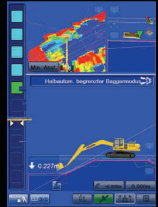
Teilautomatisches Abziehen einer Böschung auf dem Komatsu-Übungsgelände mit dem PC290 LCi mit iMC.2.0. Die Assistenzsysteme
