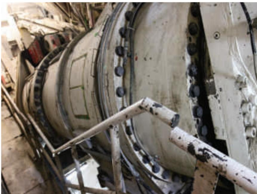
Oben: Diese Motoren versetzen das mehr als 11 Meter durchmessende Schneidrad der Tunnelvortriebsmaschine in Rotation. Zusammen kommen sie auf über 10.000 PS.
