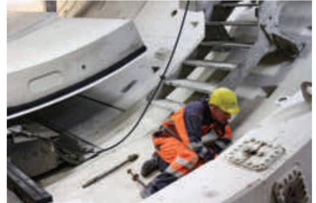
Mit diesen ringförmig um den Bohrkopf verteilten Hydraulikzylindern stemmt sich das Schneidrad gegen den Berg
